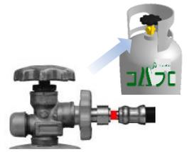
地震などにより、ガスボンベが転倒しそうになると、ホースの付け根で自動的にガスを停止
