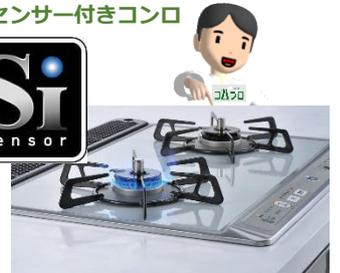
バーナーの中心部の円柱型の出っ張りがSiセンサー。フライパンや天ぷら油の異常な温度上昇を防止して、火災を防止します。新しい商品には全て付いています。
